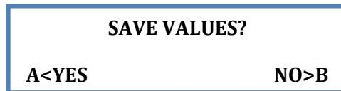
Mit der Taste «B» werden die aktuellen Messwerte nicht abgespeichert, und es kann die nächste Messung gestartet werden.
