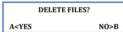
Wenn der gesamte Speicher nicht gelöscht werden soll, muss Taste «B» gedrückt werden und das Gerät ist wieder bereit für die nächste Messung. Das letzte Messergebnis verschwindet aus dem internen Speicher und kann nun nicht mehr abgespeichert werden.
